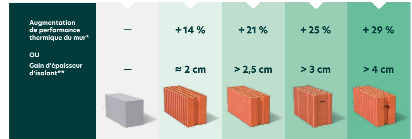
\*Augmentation de performance thermique du mur, à épaisseur égale, si associée à une laine minérale GR32 épaisseur 120 mm ( $R_{th} = 3,75$ ).
