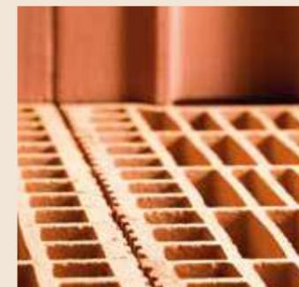
Une maçonnerie de « type a » permet de diviser par 2 les ponts thermiques par rapport à une maçonnerie courante, en angle rentrant. Ce bénéfice permet également d'améliorer le Bbio.
