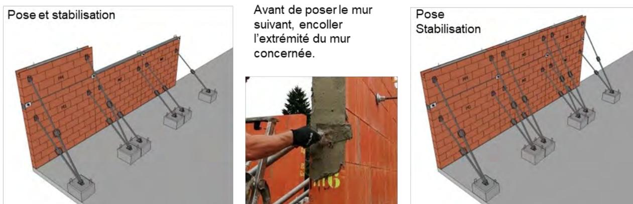
FIGURE 36 : POSE DES TIRANT-POUSSANT DANS LE CAS DE MURS SUPERPOSES
