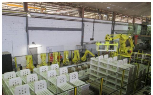
En 2017, L'usine de Castelnaudary a robotisé sa ligne « CASTEL 1 » automatisant l'empilage / dépilage des tuiles et accessoires. Ceci a permis de réduire la pénibilité du poste de manutentionnaire qui a évolué vers celui de conducteur d'installation
